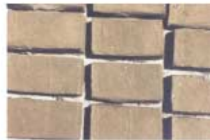
Geformte Steine liegen zum Austrocknen bereit.
