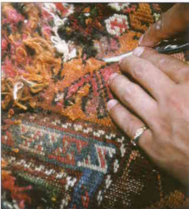
Le chef d'atelier rase le velours fraîchement noué à la hauteur adéquate
